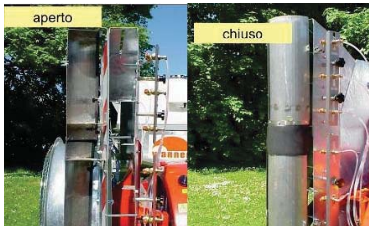
Figura 10 Paratia mobile per la chiusura del flusso d'aria su un lato dell'irroratrice per colture arboree.
