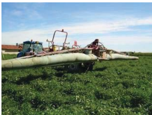
Figura 7 Barra irroratrice con manica d'aria.
